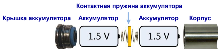
Аккумуляторы С-типа, установленные с контактной пружиной
